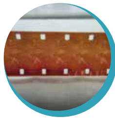
Fade อาการของสีฟิล์มภาพยนตร์ที่ซีดจาง
