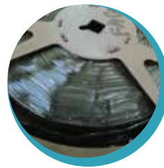
Spoking เป็นลักษณะที่ฟิล์มมีอาการโค้งงอ หักมุมเป็นเหลี่ยมและคลื่น
