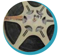
Blocked อาการของฟิล์มภาพยนตร์ที่แข็งติดกันเป็นก้อน
