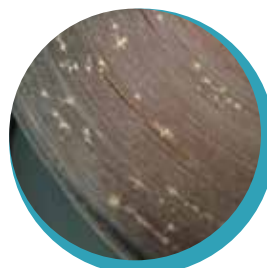
Mould คือฟิล์มภาพยนตร์ที่มีราขึ้น
