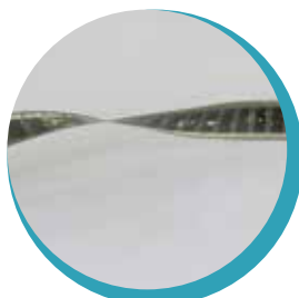
Twist อาการของฟิล์มภาพยนตร์ที่มีลักษณะบิดเป็นเกลียว
