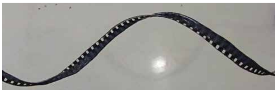
Twist อาการของฟิล์มภาพยนตร์ที่มีลักษณะบิดเป็นเกลียว
